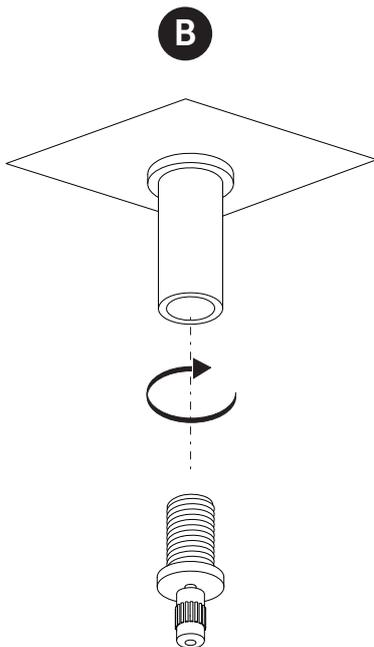
**B** • Bloccare in posizione in cavo in acciaio tramite l'apposito meccanismo di fissaggio.
