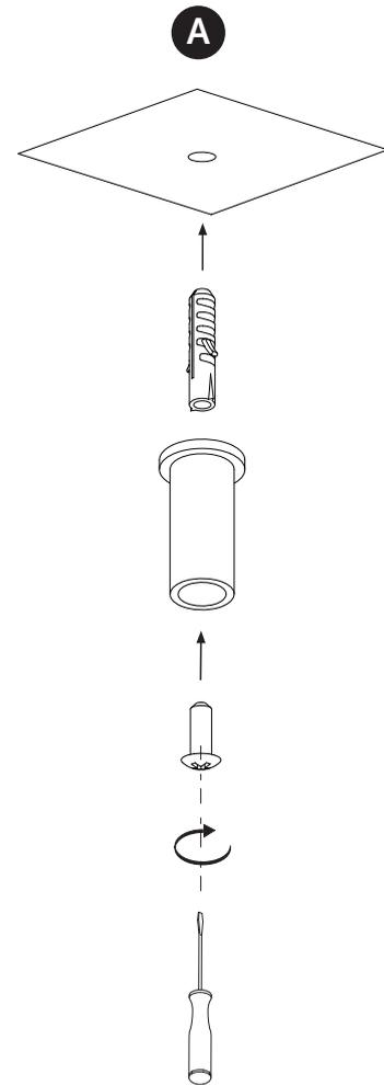
**A** • Assicurare i cilindri di supporto per i cavi in acciaio al soffitto mediante l'utilizzo di un fischer.
