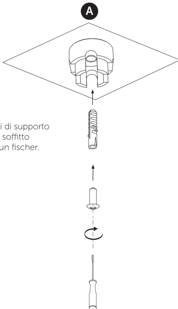
A • Assicurare i cilindri di supporto per i cavi in acciaio al soffitto mediante l'utilizzo di un fischer.
