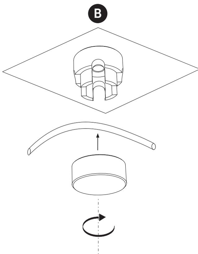
B • Bloccare in posizione in cavo di alimentazione avvitando la parte inferiore del bloccacavo.
